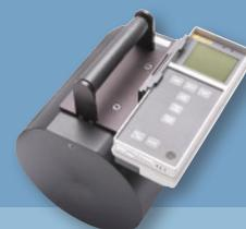
190N Portable Neutron Survey Meter
