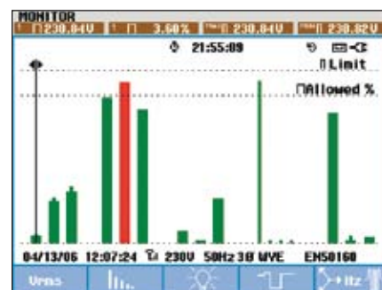
Přehled Systémového monitoru vám nabídne okamžitý pohled na to, zda napětí, harmonické, mihotání (flicker), frekvence a počet poklesů a překmitů přesahují nastavené limity. Získáte podrobný seznam všech událostí přesahujících nastavené limity
