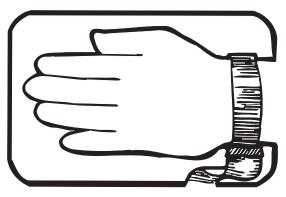
3. DISCHARGE PERSONAL STATIC BEFORE HANDLING DEVICES. USE A HIGH RESIS-TANCE GROUNDING WRIST STRAP.
